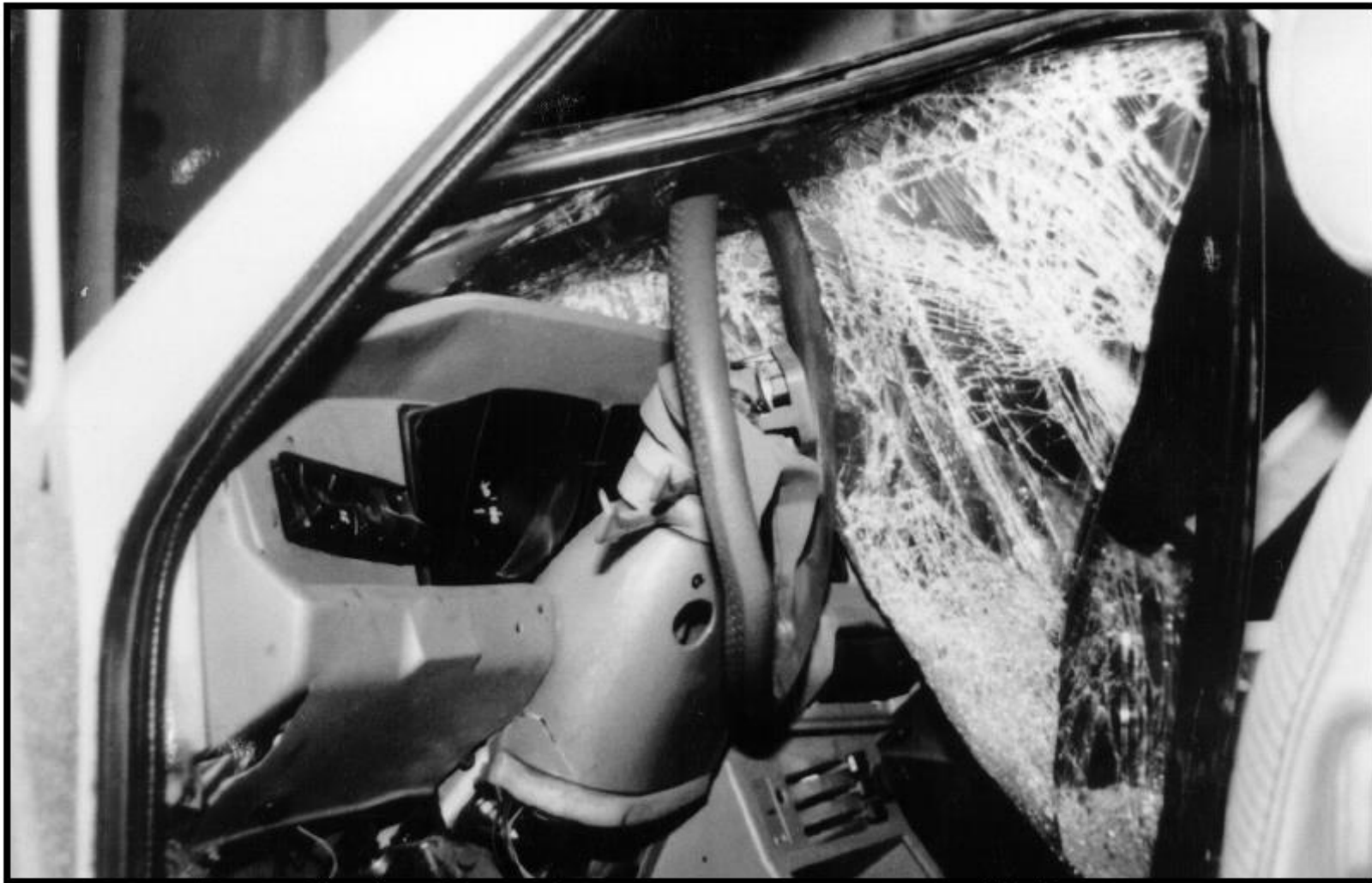
Слика бр. 15 – Оштећења точка управљача ЈУГА
